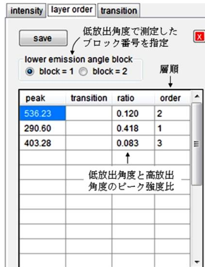
表示されている二つのピークのうちで、低放出角度で取得したスペクトルのブロック番号を指定する。COMPRO はピーク強度が大きい方のスペクトルを低放出角度で取得したスペクトルであるとしているが、そうで無い場合にはここで変更する。この場合には、第1層は 290.60eV のピークに対応する元素、第2層は 539.23eV のピークに対応する元素、第3層は 403.28eV のピークに対応する元素であると推定される。
